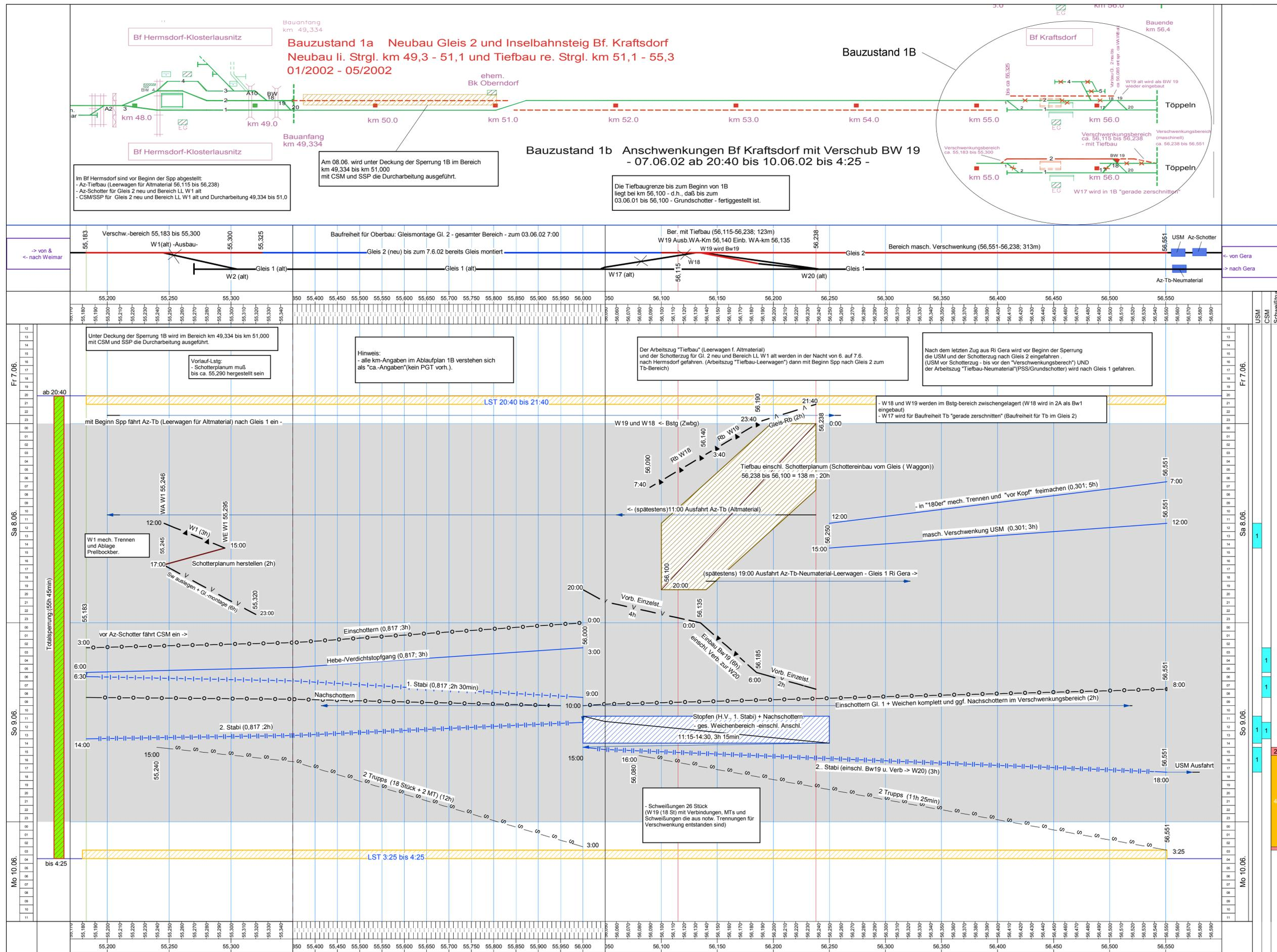
**Bauzustand 1a** Neubau Gleis 2 und Inselbahnsteig Bf. Kraftsdorf
